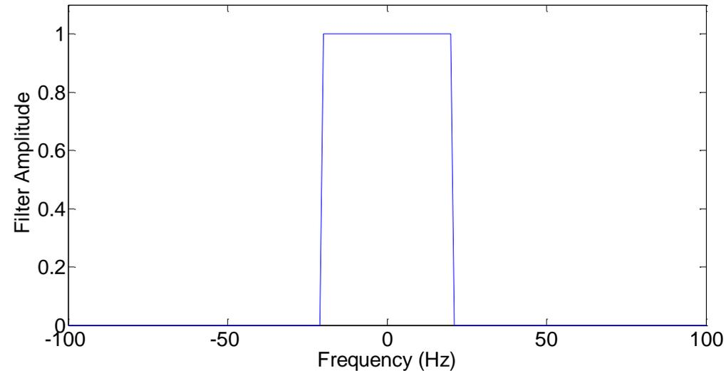
$$H_L(\omega) = \begin{cases} 1 & \text{if } |\omega| \leq \omega_0 \\ 0 & \text{if } |\omega| > \omega_0 \end{cases}$$
