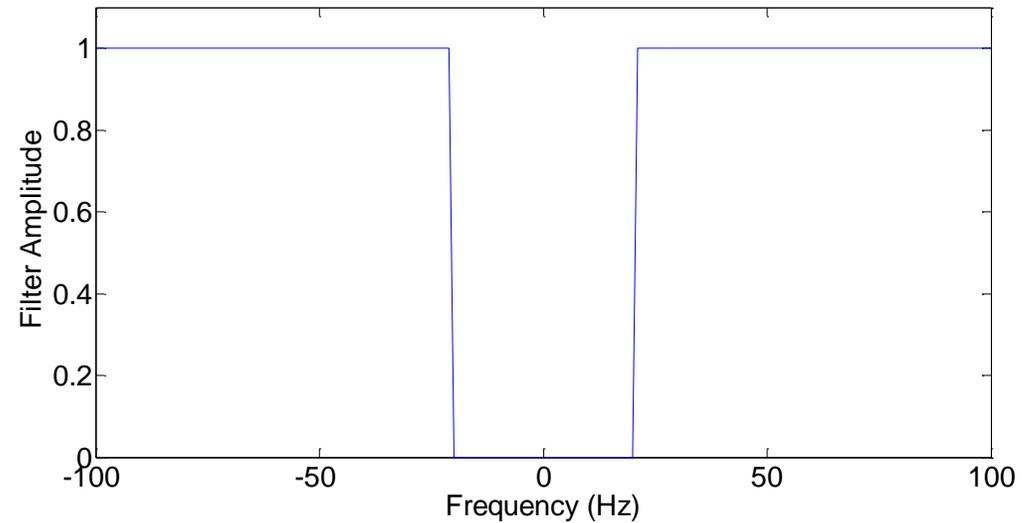
$$H_H(\omega) = 1 - H_L(\omega) = \begin{cases} 1 & \text{if } |\omega| > \omega_0 \\ 0 & \text{if } |\omega| \leq \omega_0 \end{cases}$$
